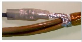
PREFERRED GROUND LEAD / DRAIN WIRE SPLICE
