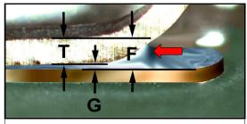
**UNACCEPTABLE INSUFFICIENT HEEL FILLET HEIGHT (F)**
