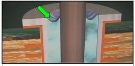
ACCEPTABLE SOLDER FILLET RECESS / SHRINKBACK
